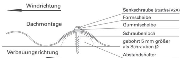
Wellplatten für die Verkleidung von Wänden können mit geeigneten Schrauben in den Tiefsicken fixiert werden.
