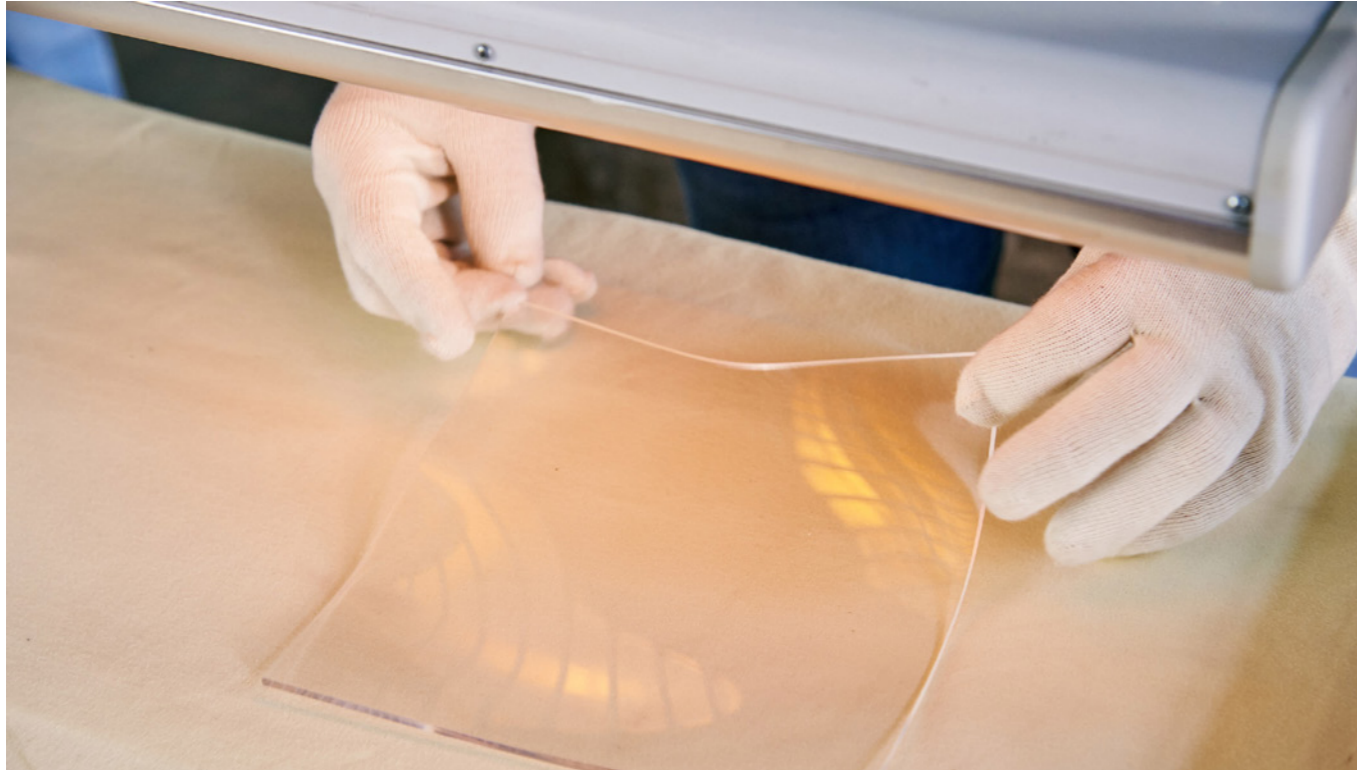
Die zugeschnittene PLEXIGLAS® Platte wird zum Erwärmen unter dem Badstrahler positioniert.
