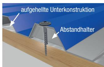
Querschnitt Befestigung der Überlappung
